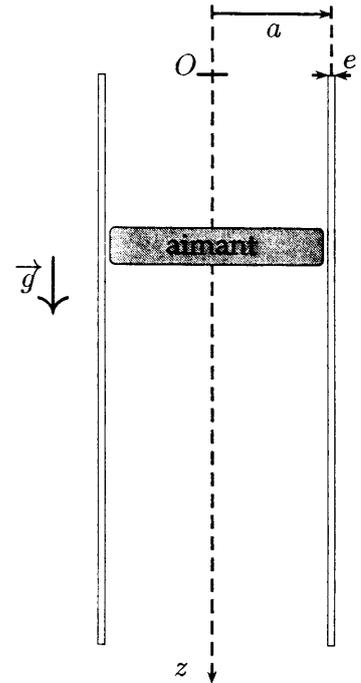
Figure 2: Chute d'un aimant dans un conducteur métallique.
